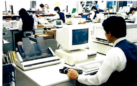
渉外係は帰店後、ハンディ端末機(左手)を親機に接続し精査処理を行う
